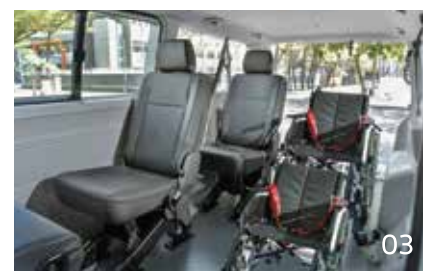
01 旋轉式收合，空間可靈活運用，不搭載輪椅乘客時可搭載戶外活動用品或利用斜坡道裝卸貨物。
